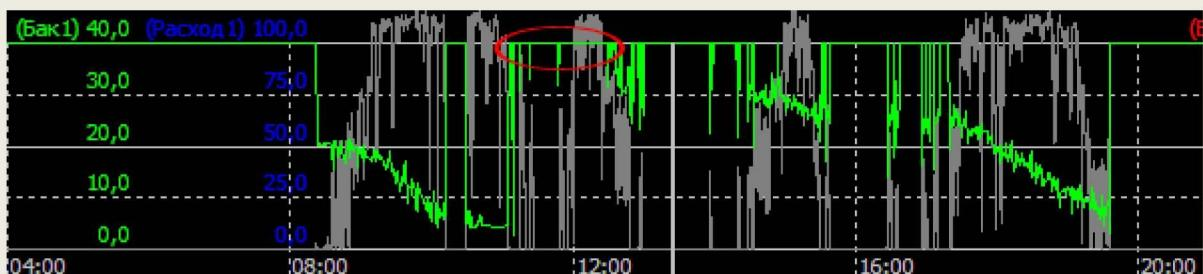
Здесь также после заправки уровень топлива продолжительное время находится в самой верхней границе. Объяснение простое – данные приходят со штатного датчика, а у него имеется так называемая «мертвая зона», где замеры физически не производятся. Выход из такой зоны на графике всегда отображается резким скачком вниз, который программа считает за слив. Меры борьбы с данным эффектом те же, что и описаны выше.
